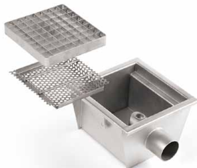
Vasca con scarico orizzontale completa di filtro prima della sifonatura, griglia in pressato decapata e brillantata, il tutto in acciaio inox AISI 304.
