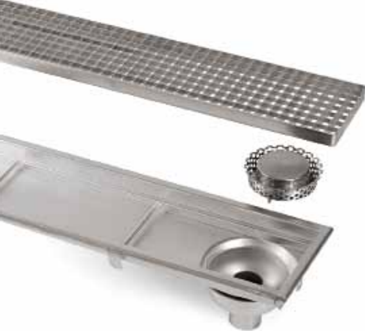
Vasca con scarico verticale completa di filtro prima della sifonatura, griglia in pressato decapata e brillantata, il tutto in acciaio inox AISI 304.
