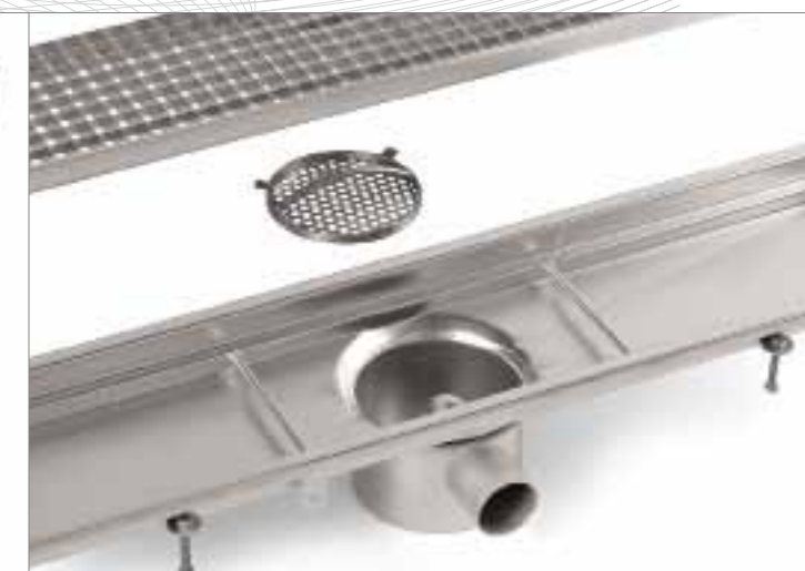
Vasca con scarico orizzontale sifonata completa di filtro, griglia in pressato decapata e brillantata, il tutto in acciaio inox AISI 304.
