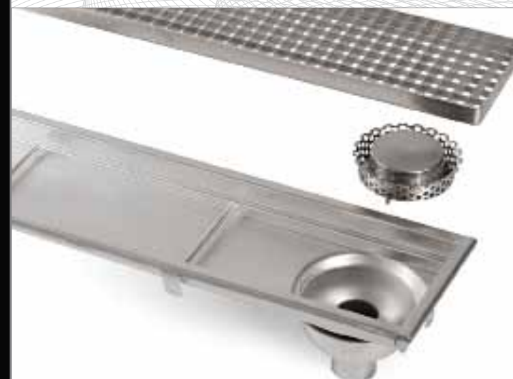
Vasca con scarico verticale completa di filtro prima della sifonatura, griglia in pressato decapata e brillantata, il tutto in acciaio inox AISI 304.
