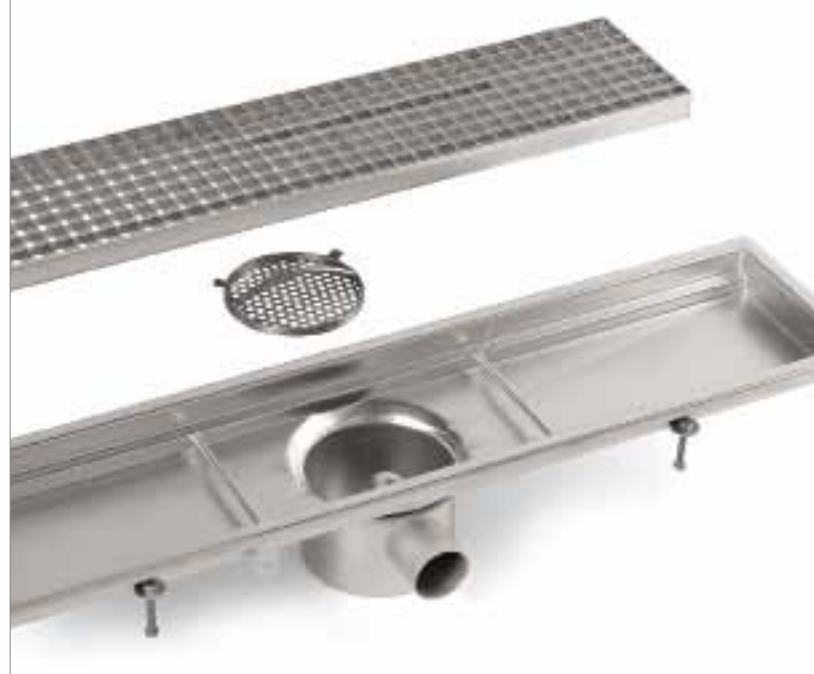
Vasca con scarico orizzontale sifonato completa di filtro, griglia in pressato decapata e brillantata, il tutto in acciaio inox AISI 304.
