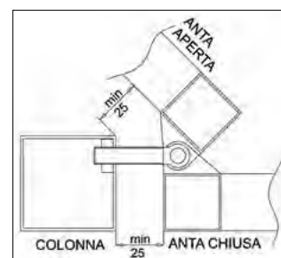
Particolare CARDINE SICURO Il CARDINE permette di mantenere un franco di sicurezza di 25 mm per tutta la sua apertura
