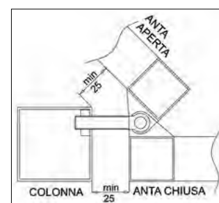
Particolare CARDINE SICURO Il CARDINE permette di mantenere un franco di sicurezza di 25 mm per tutta la sua apertura
