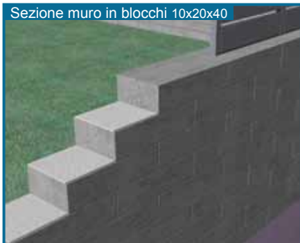
Sezione muro in blocchi 10x20x40
