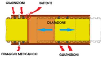
Schema di Manicotto di Dilatazione - rif.to:Tab. 9
